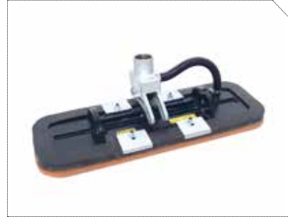
BORDSTEINSAUGPLATTE 230 X 670 MM, EINSTELLBARER WINKEL 0-90°, TRAGKRAFT 350 KG
