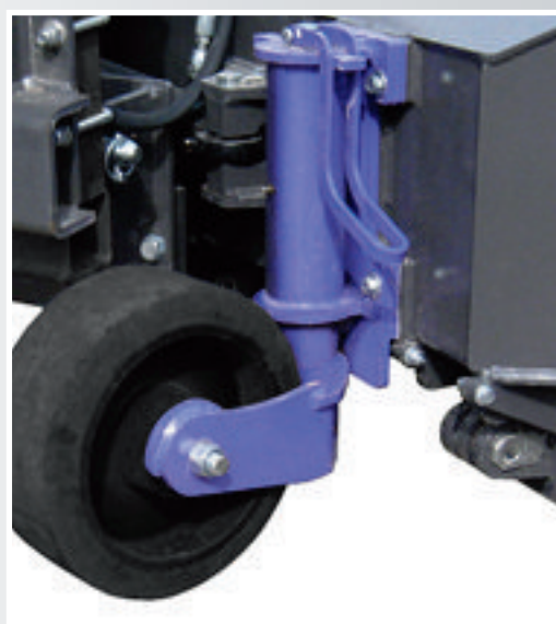
STÜTZRÄDER – für eine noch bessere Anpassung an den Untergrund, vor allem wenn nicht vereist und weich. Beim Bestellen eines Holms Knickpflugs haben Sie jetzt die Wahl zwischen Stützstellern und -rädern.
