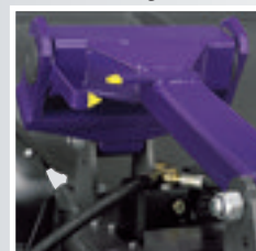
Floatarm TM – zum einfachen Regulieren des Bodendrucks unter Last.
